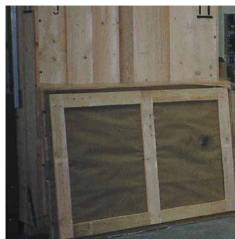
Kistendeckel mit Bitumenpapier ausgelegt.
