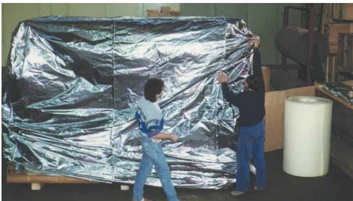
2. Die Alu-Verbundfolie wird gerade gezogen.
