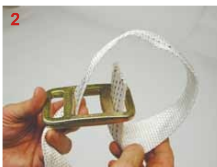
Schleife nach rechts legen und von unten durch die schmale Öffnung durchschieben.
