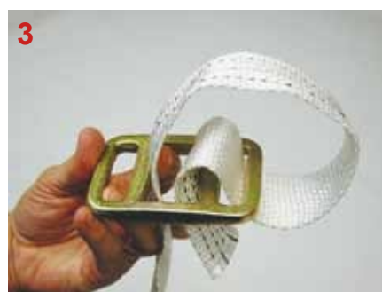
Sofort wieder von oben nach unten durch die Mitte ziehen. Band fertig umreifen und festziehen.
