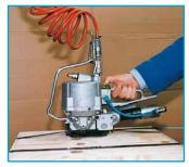
**CH45** Druckluftgerät für das rationelle Umreifen geradflächiger Packstücke. Hohe Spannkraft. Alle Funktionen auf Tastendruck. Stanzverschluss ohne Plomben. Geeignet für alle Bandqualitäten.
