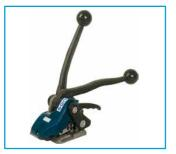
**CH47** ist ein robustes und handliches Gerät für das Umreifen geradflächiger Packstücke. Alle Funktionen mit Handhebel. Stanzverschluss ohne Plomben. Geeignet für alle Bandqualitäten.
